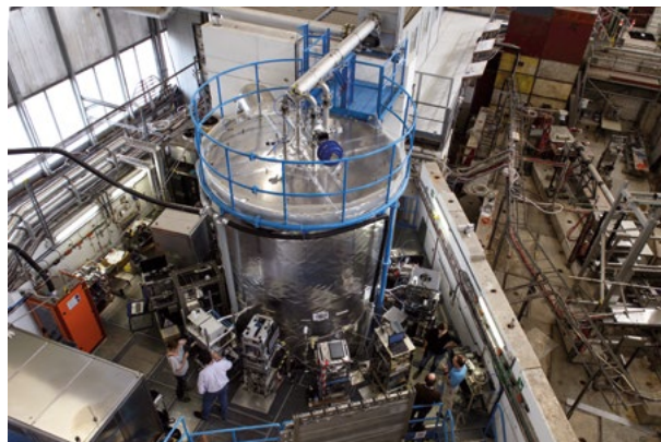
Die Wolkenkammer von CERN: Hier forschen AtmosphärenphysikerInnen im Rahmen des CLOUD-Experiments an der Bildung von Kondensationskeimen.
