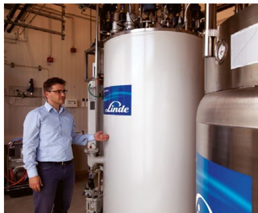
Der Verflüssiger: Das Heliumgas wird hier immer wieder zusammengepresst und entspannt, sodass es sich stufenweise abkühlen kann. Bild: © Michael Schwettmann, RUB News
