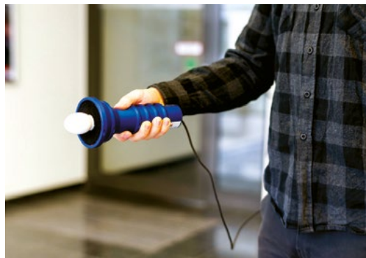
Virtueller Blindenstock: Mittels radargestützter Systeme kann die Umgebung wahrgenommen werden.
